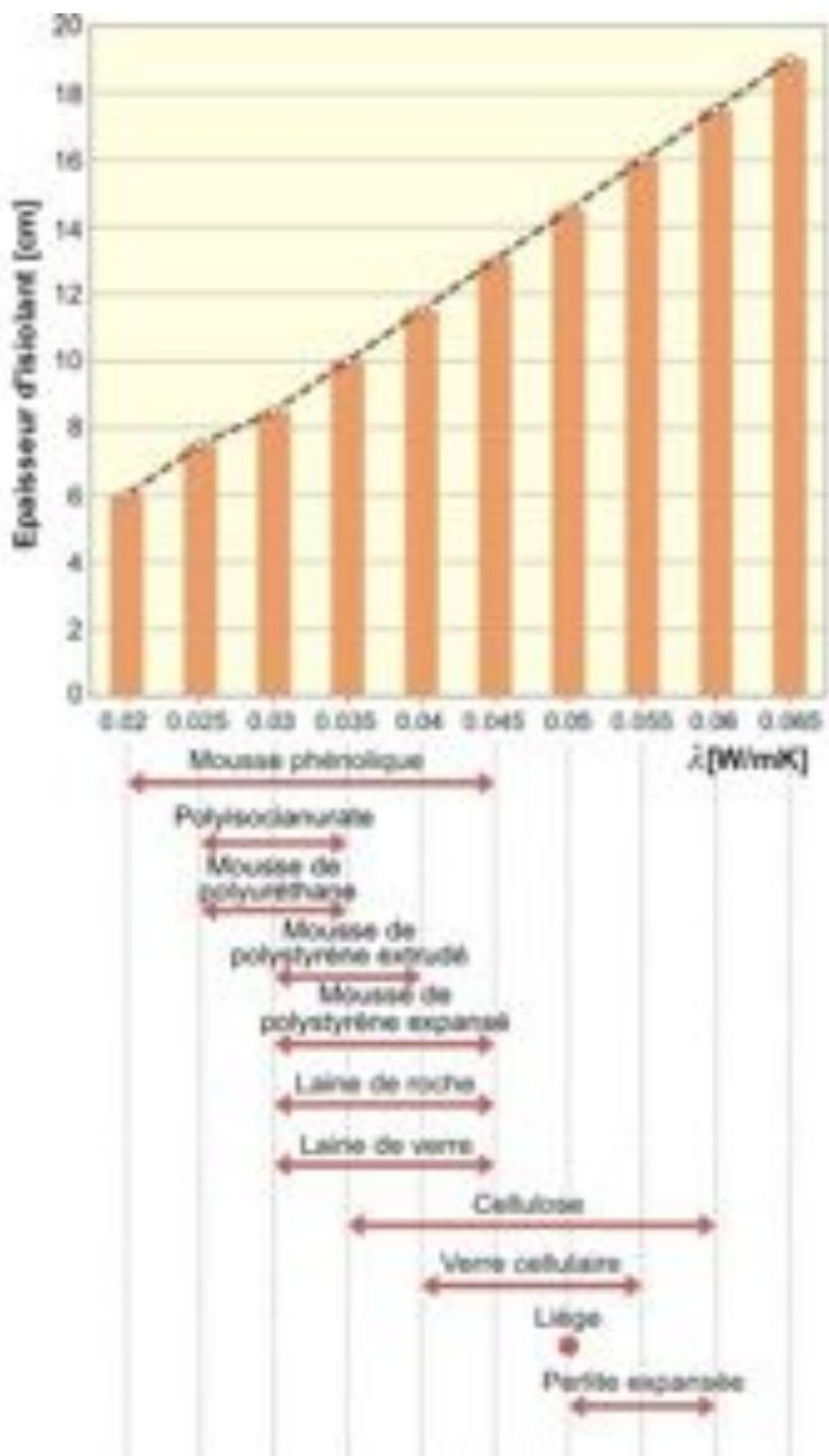
Figure 30 : Conductivité thermique de quelques isolants et leur épaisseur pour atteindre une résistance thermique de  $3 \text{ m}^2 \cdot \text{K}/\text{W}$
