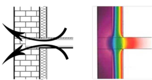
Figure 36 : température interne dans une paroi en Isolation Thermique par l'Intérieur
