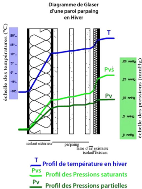
Fig. 44 : Diagramme de Glaser en Hiver d'une paroi isolée par l'extérieur
