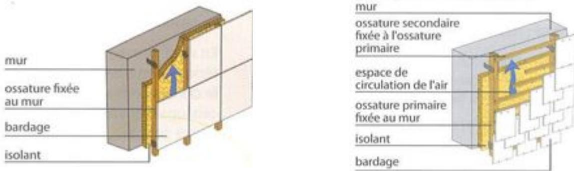
Fig. Figure 25 : Bardage à ossature double
