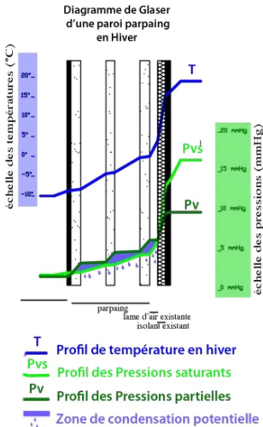
Fig. 41 : Diagramme de Glaser en Hiver d'une paroi parpaing
