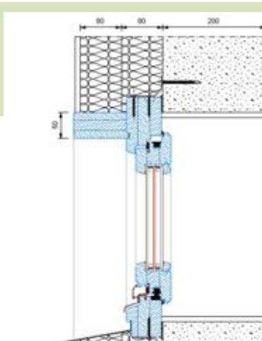
Figure 7 : Fenêtre dans le plan de l'isolation
