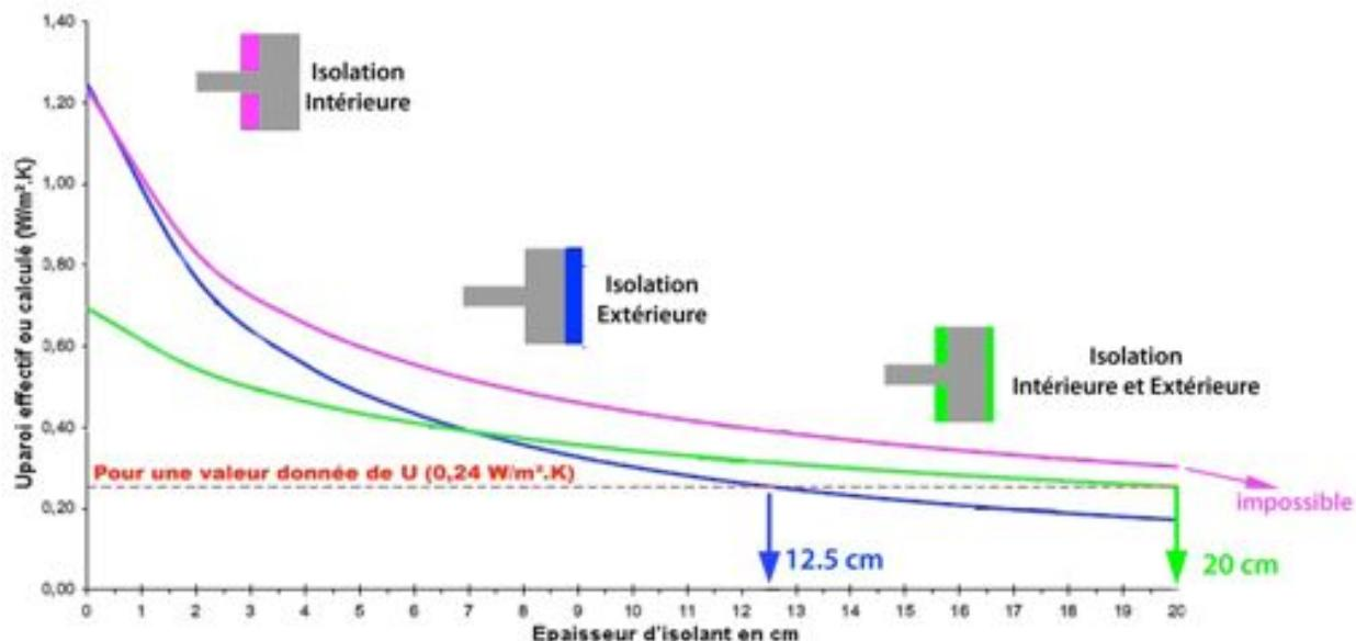
Figure 37 : Comparaison de l'épaisseur d'isolant nécessaire entre isolation intérieur, extérieur et mixte (source J-P. MOYA)
